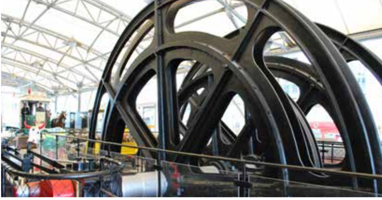
Galata ve İstiklal Caddesi arasındaki tünelde vagonları hareket ettirmek için kullanılan, 1873 yılında Fransa'da üretilmiş, çift silindirli büküm yatay buhar makinesi.
