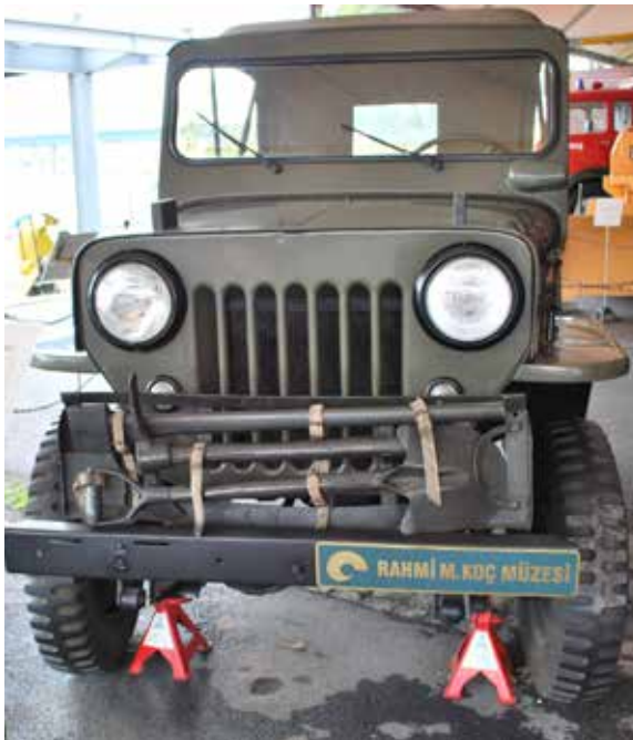
1963 Türk Willys Overland Universal Jeep CJ-3B, Türkiye’deki ilk araç fabrikası olan ve 1954 yılında kurulan Türk Willys Overland A.Ş. de üretilmiştir. Büyük ve güçlü “F Başlı” motorunun üzerini örtmek için daha yüksek olarak üretilen kaputu sayesinde, İkinci Dünya Savaşı sırasında üretilen modellerden kolaylıkla ayrılır.
