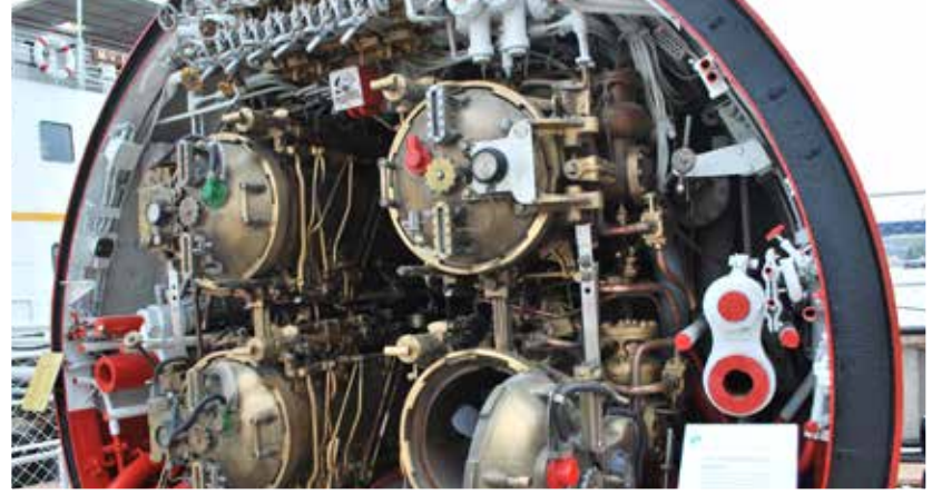
Balao sınıfı TCG Çanakkale Denizaltısından alınan bu kesitte torpido tüpü kapakları ve kontrol mekanizmaları görülmektedir. Denizaltının çevresindeki çeliğin inceliği dikkat çekmektedir. (Sadece 18 mm)
